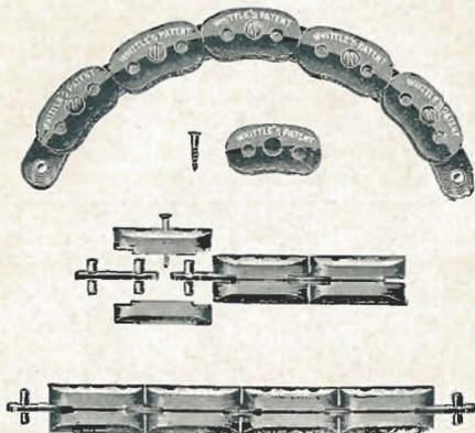
A la place de la courroie torse de la motorette n° 2, nous pouvons livrer une courroie-chaîne, qui évite tous les ennuis de la courroie ronde, tout en étant d'une très grande durée. Elle demande les mêmes soins qu'une courroie ordinaire, c'est-à-dire qu'il la faut bien graisser, avec de l'huile de ricin de préférence. Pour la raccourcir on ôte un maillon, que l'on conserve, pour remplacer au besoin un autre.
