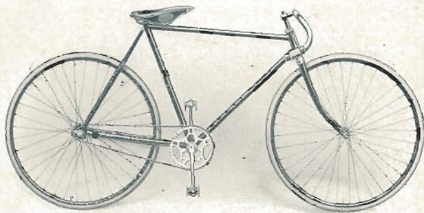
Le modèle **AC** ne diffère du **AL** que par le tube supérieur qui est plongeant. Il est livré avec pignon de 50 dents et 16, 18 et 20 dents, et avec des pneumatiques de 28, 32 et 35 <sup>m/m</sup>, mais il ne peut pas recevoir de garde-boue.
