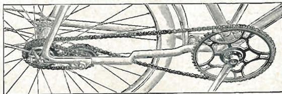
Le moyeu de la roue arrière porte deux pignons à roue libre. La chaîne qui vient du pédalier enveloppe l'un de ces pignons et son brin inférieur passe sur un pignon intermédiaire, monté sur un axe parallèle au moyeu et fixé sur la fourche arrière. Ce pignon est solidaire d'un second pignon monté sur le même axe et qui est relié par une petite chaîne courte à la seconde roue libre du moyeu.
