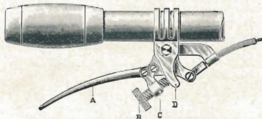
Ce levier fonctionne comme le levier simple. Si l'on veut bloquer la machine ou arrêter le levier dans une position quelconque pendant une longue descente, il suffit de tourner la vis B. Cette manœuvre est très facile, un seul doigt suffit pour la faire avancer ou reculer. Ce ralentisseur est très sensible, aussi sûr que simple, et il ne devrait manquer à aucune bicyclette de tourisme.
