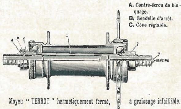
Moyeu " TERROT " hermétiquement fermé, à graissage infallible.
