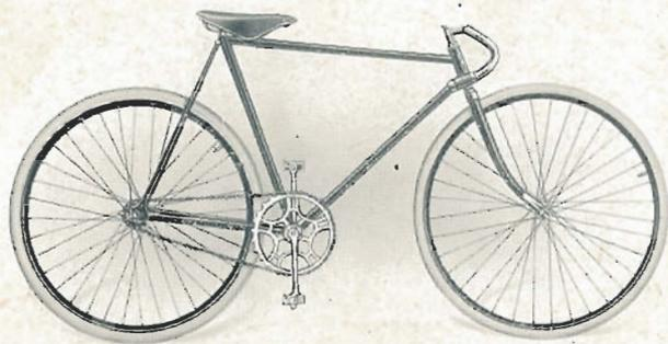
Ce modèle est spécialement construit pour la course. L'arrière du cadre est très raccourci et sa forme diffère des autres modèles.
