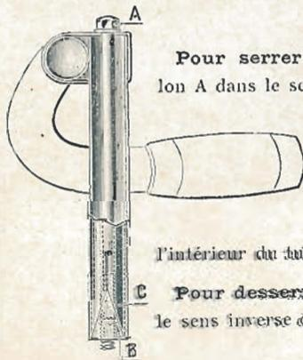
**Pour serrer le guidon**, tourner le bouton A dans le sens de l'aiguille d'une montre. L'écrou conique B remonte alors et écarte les parties extensibles du tube plongeur C, faisant ainsi serrage dans l'intérieur du tube de la fourche.
