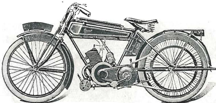
**Moteur "Terrot"** spécial à haute compression à 2 temps et distribution automatique par 3 lumières. Aspiration et précompression dans le carter. Alésage 57  $\frac{m}{m}$ . Course 68  $\frac{m}{m}$ . Cylindrée 175 cc.
