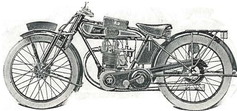
**Moteur** monocylindrique "Terrot-Jap" 4 temps à soupapes en dessus commandées par culbuteurs. Alésage 62,5. Course 80  $\frac{3}{4}$ . Cylindrée 249 cc.
