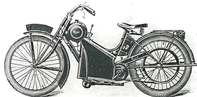
**Moteur "Terrot"** à 2 temps et distribution automatique par 3 lumières. Aspiration et précompression dans le carter. Alésage 57  $\frac{m}{m}$ . Course 68  $\frac{m}{m}$ . Cylindrée 175 cc.
