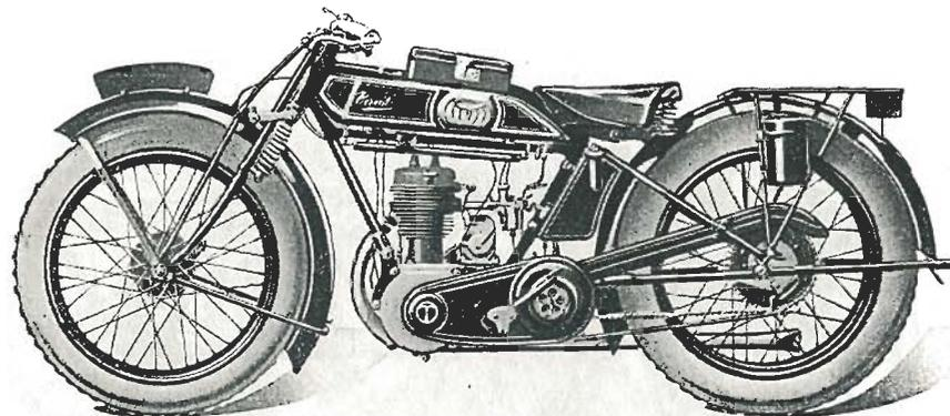
**Moteur** monocylindrique à 4 temps, à soupapes latérales. Alésage  $70 \frac{m}{m}$ . Course  $90 \frac{m}{m}$ . Cylindrée 346 cc.
