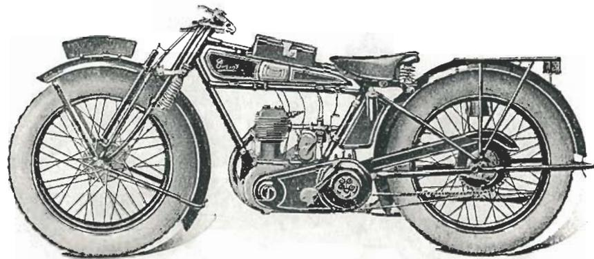
**Moteur** monocylindrique "Terrot-Jap" 4 temps à soupapes latérales. Piston aluminium. Alésage 64,5. Course 76  $\frac{7}{16}$ . Cylindrée 249 cc.
