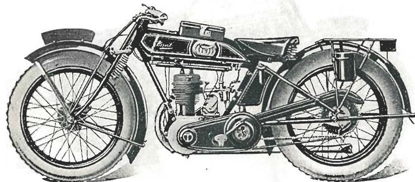
Moteur monocylindrique à 4 temps, à soupapes latérales. Alésage 70 <sup>mm</sup>/<sub>16</sub>. Course 90 <sup>mm</sup>/<sub>16</sub>. Cylindrée 346 cc.
