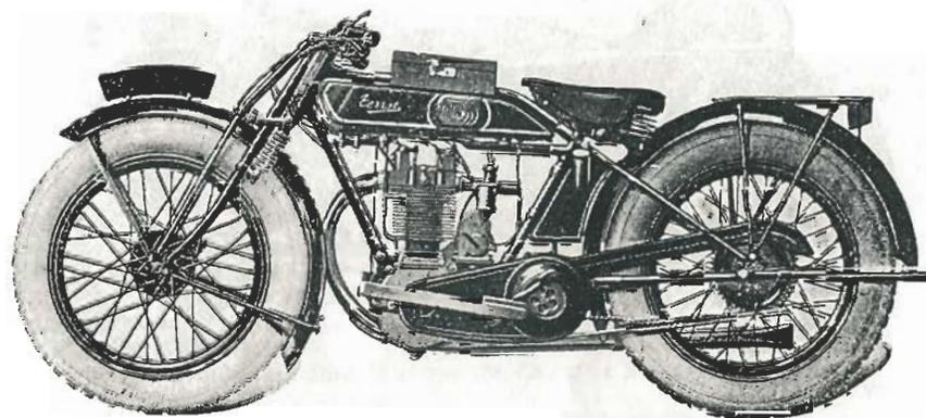
**Moteur** monocylindrique "Terrot-Jap", 4 temps, à soupapes en dessus commandées par culbuteurs. Piston aluminium. Alésage 70  $\frac{m}{m}$ . Course 90  $\frac{m}{m}$ . Cylindrée 346 cc.
