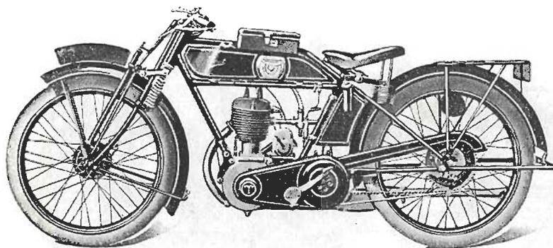
**Moteur** monocylindrique à 4 temps, à soupapes latérales. Alésage  $70 \frac{m}{m}$ . Course  $90 \frac{m}{m}$ . Cylindrée 346 cc.
