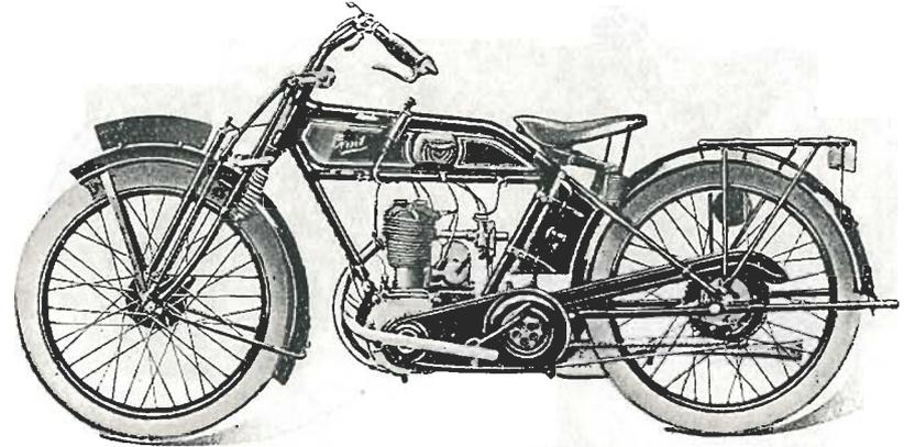
**Moteur** monocylindrique 4 temps, à soupapes latérales. Alésage 70  $\frac{3}{4}$ . Course 90  $\frac{3}{4}$ . Cylindrée 346 cc.
