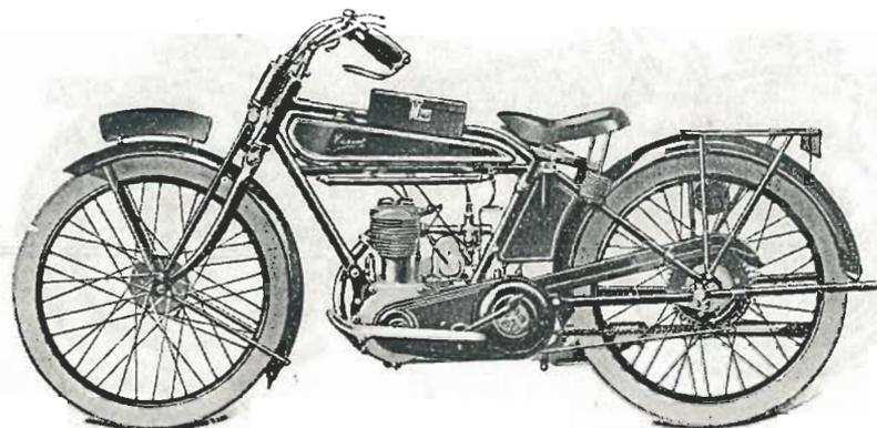
**Moteur** monocylindrique "Terrot-Jap" 4 temps à soupapes latérales. Piston aluminium. Alésage 64,5. Course 76  $\frac{7}{16}$ . Cylindrée 249 cc.
