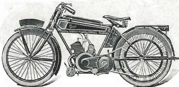
**Moteur** "Terrot" spécial à haute compression à 2 temps et distribution automatique par 3 lumières. Aspiration et précompression dans le carter. Alésage 57  $\frac{m}{m}$ . Course 68  $\frac{m}{m}$ . Cylindrée 175 cc.
