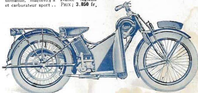
**TYPE LDC. — 2 CV DAME CONFORT.** — Moteur 2 temps 57 × 68. — Boîte 2 vitesses. — Débrayage à disques multiples. — Mise en marche par pédale. — Transmission par chaînes. — Fourche à parallélogramme avec amortisseurs. — Cadre ouvert. — Capot pare-jambes instantanément démontable sans outils. — Pneus ballon 25 × 3. — Sacoche à serrure. — Selle souple grand modèle. — Bidon de secours. — Marchepieds wagon. — Guidon semi-relevé. PRIX 3.300 fr.
