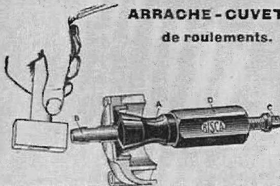
Choisir parmi les extensions (A) celui se rapportant au diamètre de la cuvette à enlever. Pousser celui-ci à fond. Maintenir l'appareil (B) en vissant la vis (B) jusqu'à l'écartement de l'extensible. Ensuite visser jusqu'à fond de course la vis (C). L'extraction s'opère par frappe avec une massette.
