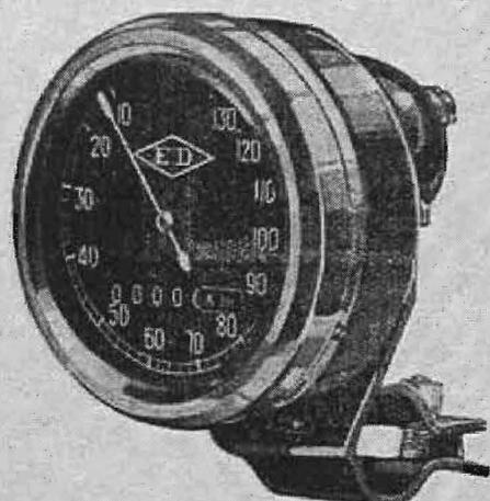
N° 24258. — Type I, diamètre 87 mm, jusqu'à 130 ou 140 kms, compteur totalisateur jusqu'à 100.000 kms, se fixe sur le guidon ou sur fourche à parallélogramme, avec engrenage sur roue avant.
