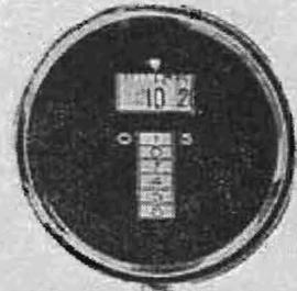
Indicateur de vitesse par tambour gradué, totalisateur jusqu'à 100.000 kilomètres avec hectomètres.
