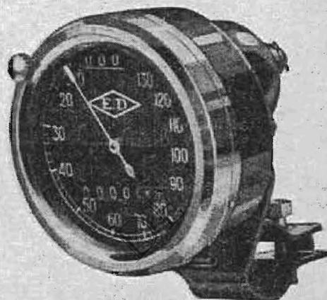
N° 24185. — Type J, diamètre 87 mm, jusqu'à 130 ou 140 kms. Compteur journalier jusqu'à 1.000 kms; compteur totalisateur jusqu'à 100.000 kms, se fixe sur le guidon ou sur fourche à parallélogramme, avec commande par engrenage sur roue avant.
