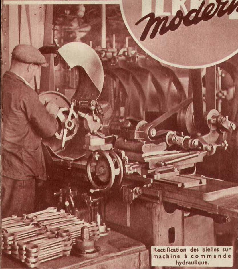
Rectification des bielles sur machine à commande hydraulique.
