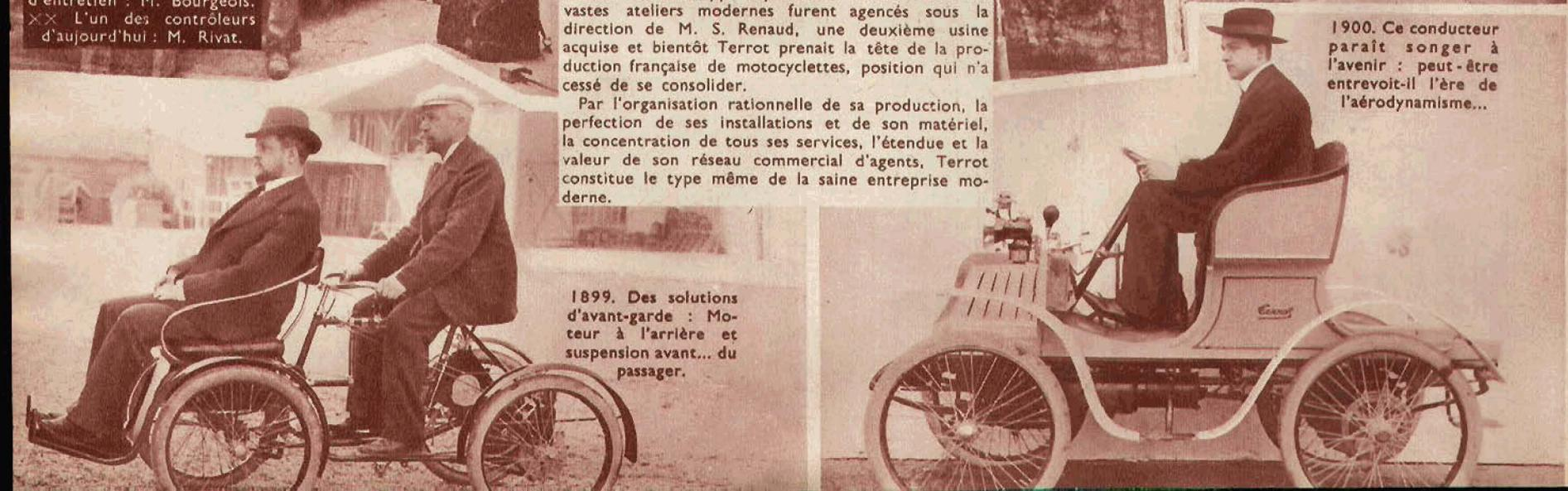
1899. Des solutions d'avant-garde : Moteur à l'arrière et suspension avant... du passager.
