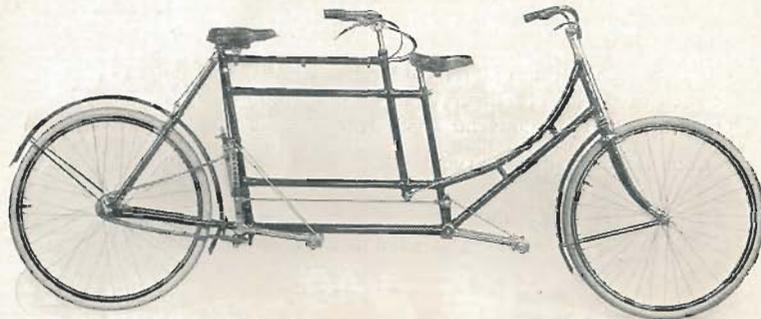
La cycliste est placée à l'avant, elle n'a qu'à pédaler. Le cycliste à l'arrière fait manœuvrer le changement de vitesse, comme dans une Levo simple, sans autre précaution. Direction double, 2 freins puissants. Hauteur du cadre avant 47 °/m, arrière 57 °/m.
