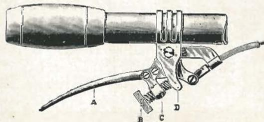
Ce levier fonctionne comme le levier simple. Si l'on veut bloquer la machine ou arrêter le levier dans une position quelconque pendant une longue descente, il suffit de tourner la vis B. Cette manœuvre est très facile, un seul doigt suffit pour la faire avancer ou reculer. Ce ralentisseur est très sensible, aussi sûr que simple, et il ne devrait manquer à aucune bicyclette de tourisme.
