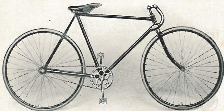
Le modèle **AC** ne diffère du **AL** que par le tube supérieur qui est plongeant. Il est livré avec pignon de 50 dents et 16, 18 et 20 dents, et avec des pneumatiques de 28, 32 et 35 m/m, mais il ne peut pas recevoir de garde-boue.
