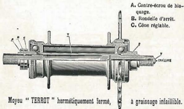
**Réglage des moyeux.** — Après avoir desserré l'écrou extérieur du côté du cône réglable, débloquent au moyen de la clef spéciale à ergot le contre-écrou A, serrer légèrement le cône C, rebloquer le contre-écrou et resserrer l'écrou extérieur.
