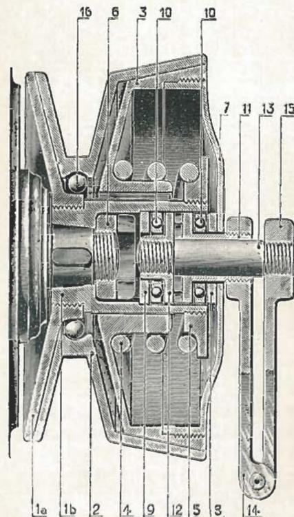
Notre poulie à débrayage est fixée au moteur, à la place de la poulie ordinaire. Elle est actionnée par une petite manette, placée au guidon, à la portée de la main gauche.
