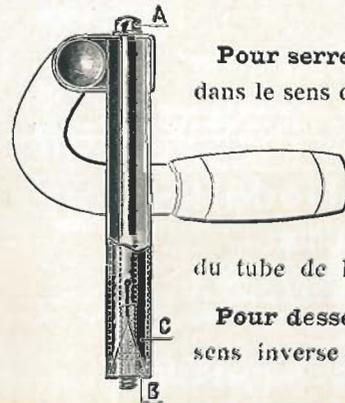
Pour serrer le guidon, tourner le boulon A dans le sens de l'aiguille d'une montre. L'écrou conique B remonte alors et écarte les parties extensibles du tube plongeur C, faisant ainsi serrage dans l'intérieur du tube de la fourche.
