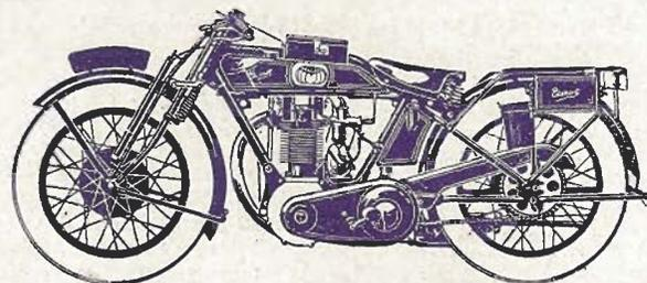
**TYPE "NSS". — 5 CV "SUPERSPORT" 500 cc. — Moteur à culbuteurs. — Repose-pieds caoutchouc réglables et Guidon TT réglable. — Commande de pompe à main par manette au guidon. PRIX : 7.600 fr.**
