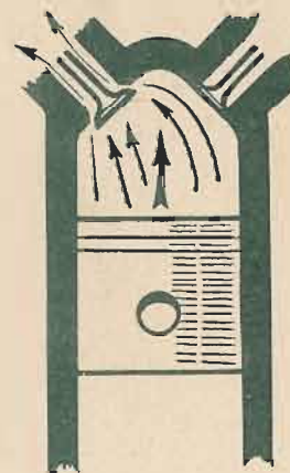
QUATRIEME TEMPS (échappement) Après avoir atteint le point le plus bas de sa course (P.M.B.), le piston remonte à nouveau. La soupape d'échappement s'est ouverte et en remontant, le piston évacue hors du cylindre, les gaz brûlés pendant l'explosion.
