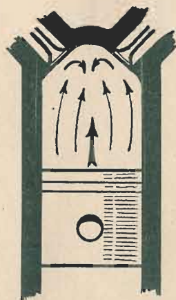
DEUXIEME TEMPS (compression) La soupape d'admission s'est fermée et le piston a changé de sens. En remontant de bas en haut, le piston comprime les gaz introduits précédemment.
