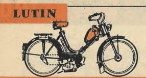
Même cadre et même équipement que les Terromatic et Magnamatic. Moteur horizontal avec débrayage instantané et décompresseur synchronisé. Entraînement par galet à pression constante. Vitesse 35 km à l'heure. Trois modèles: "Standard", "Ville" et "Luxe".
