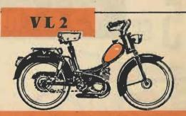
Cyclomoteur de luxe. Suspension intégrale : à l'avant par fourche télescopique, à l'arrière par bras oscillants et amortisseurs. Transmission à 2 vitesses. Freins type auto avant et arrière. Réservoir de 5 litres.
