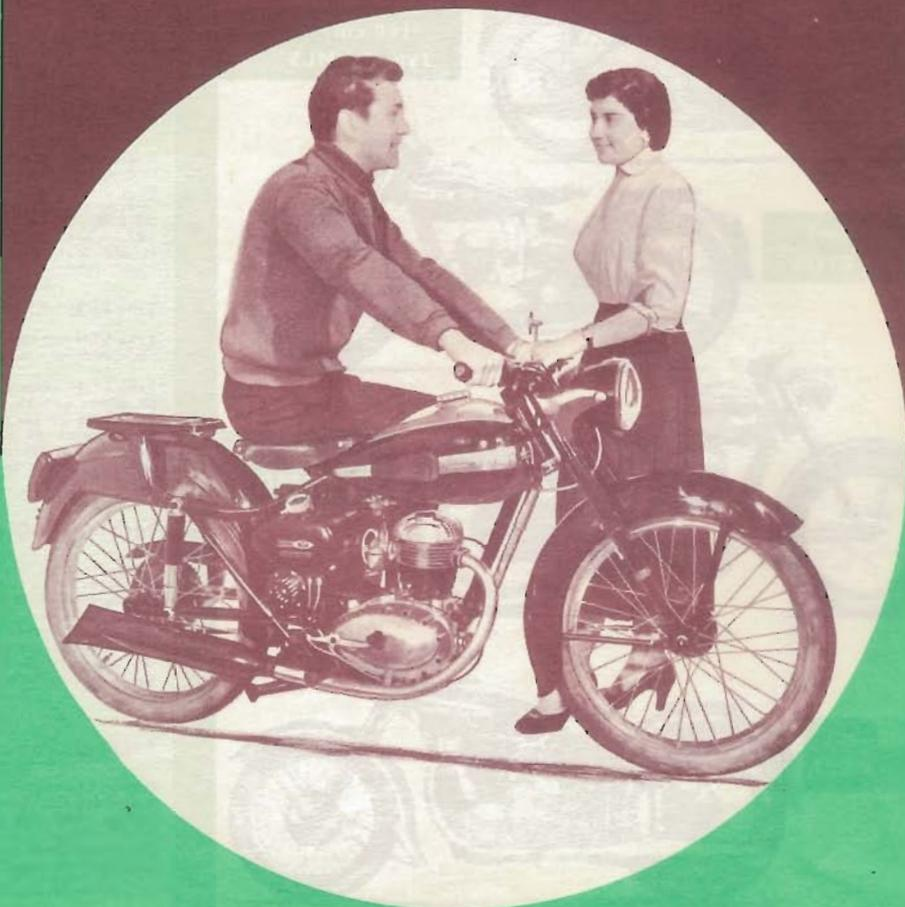
**SPÉCIFICATIONS :** MOTORETTE EMS I - 1 CV, 125 cc., 4 temps à culbuteurs à haut rendement, allumage et éclairage par volant magnétique, 4 vitesses par sélecteur, fourche télescopique, cadre à suspension arrière oscillante, jantes et garde-boue émaillés, garde-boue enveloppant, compteur kilométrique, avertisseur électrique, outillage. Supplément prévu de série : calandre de réservoir.
