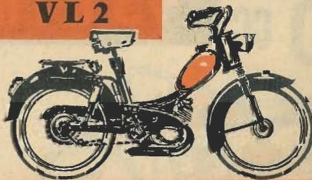
Cyclomoteur de luxe. Suspension intégrale : à l'avant par fourche télescopique, à l'arrière par bras oscillants et amortisseurs. Transmission à 2 vitesses. Freins type auto avant et arrière. Réservoir de 5 litres.
