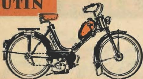
Même cadre et même équipement que les Terromatic et Magnamatic. Moteur horizontal avec débrayage instantané et décompresseur synchronisé. Entraînement par galet à pression constante. Vitesse 35 km à l'heure. Trois modèles : "Standard", "Ville" et "Luxe".
