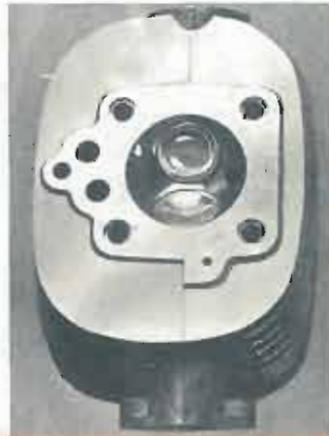
La chambre de combustion est rigoureusement hémisphérique. Soupapes légères en tulipe. Larges ailettes de refroidissement.
