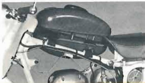
Le réservoir monté sur tampons en caoutchouc est rapidement démontable pour faciliter l'accès au moteur. Il est maintenu en place sans aucun boulon. (fixation Brevetée Terrot).
